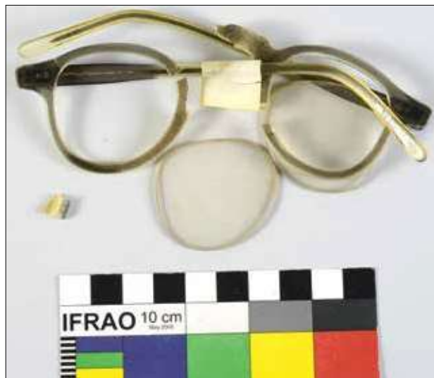
Obr. 3: Brýle 4539/1993 – materiál rozlámaný, typické poškození pro nitrát nebo acetát celulózy
